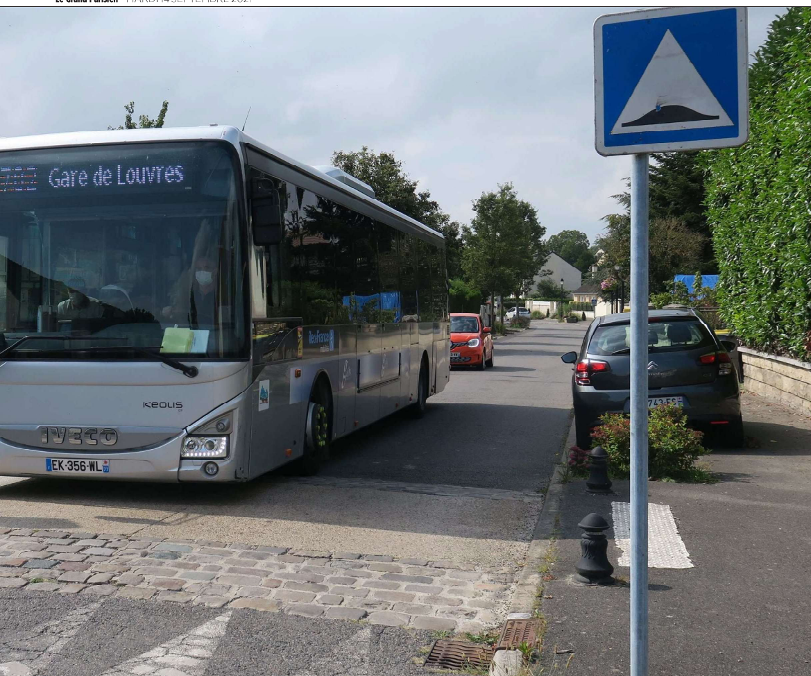
Moussy-le-Neuf (Seine-et-Marne), le 31 août. Plusieurs dos-d'âne ralentissent les véhicules de l'avenue Pasteur, dont les bus de la ligne 702. Ces équipements sont pourtant interdits sur les axes utilisés par les transports en commun, selon un décret du 27 mai 1994.
